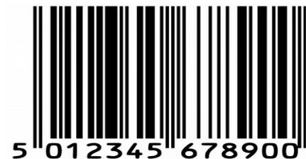
Abbildung 24: GTIN-Barcode, die 0 am Ende bildet die Prüfziffer
